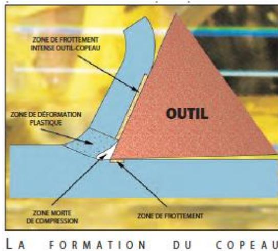
L'usure outil, découle des sollicitations mécaniques très sévères à l'interface copeau-outil et outil-pièce, accentuée par les effets thermiques.
